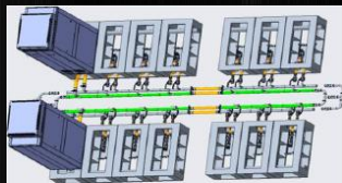
液冷二次侧环管路
