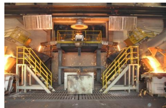
热风水冷富氧冲天炉与感应电炉双联熔炼
