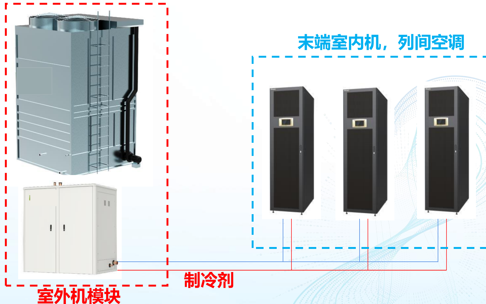
蒸发冷热管自然冷系统运行原理图
